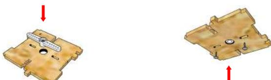
**3** Con el tornillo incluido con el servomotor, une el grupo de piezas del paso anterior atornillándolas sobre el eje del servomotor del paso 1. Mantén la orientación de las piezas.
