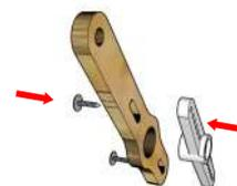
**7** Considera lo establecido en el paso 4 para formar el último de los lados de la caja. En este paso utilizaras la pieza #4, el servomotor de función *altura* y el soporte #5 restante.
